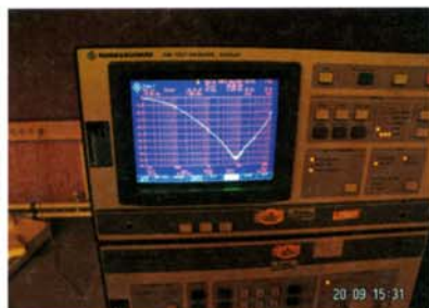
Bild 7: Messaufbau der Einfügedämpfungsmessung
