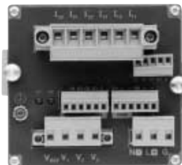
Rückseite des ION 7330 Grundmodells mit Stiftleisten-Anschluss
